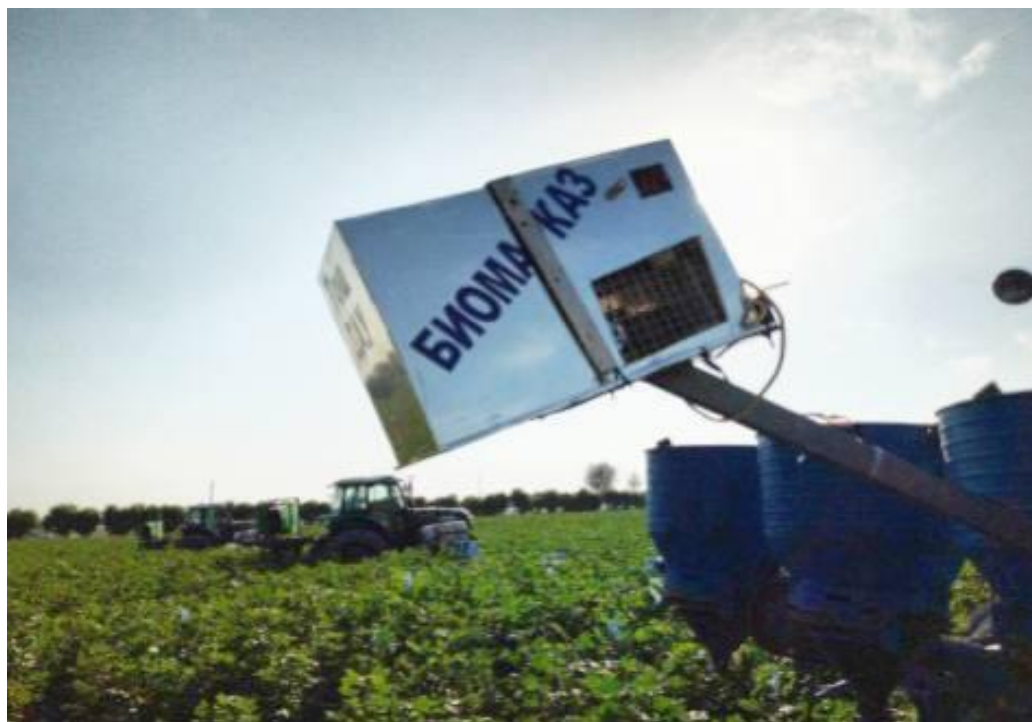
Рисунок-2 Устройства для расселения трихограммы воздушным аэродинамическим способом прикрепленный к тракторному агрегату.
